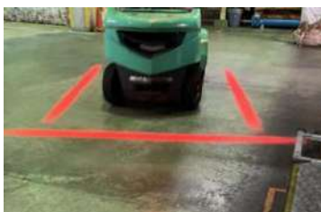
重機稼働中ライトにより視覚化
